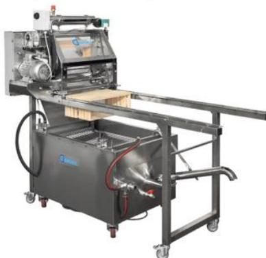
**DISOMELTER**, disopercolatrice a coltelli vibranti riscaldati completa di telaio e fondicera diretto. Il fondicera separa la cera fusa dal miele, mantenendo integre le proprietà del prodotto.
